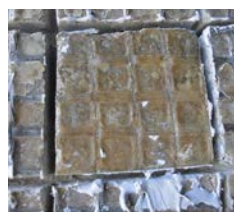
写真-5 引張強度試験後の状況
