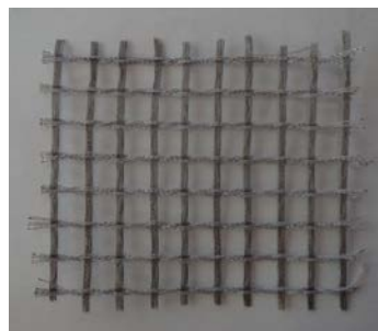
写真-2 製織後のバサルトネットの外観
