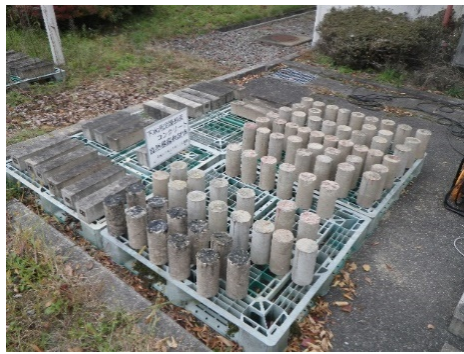
図-3 山間部自然曝露供試体
