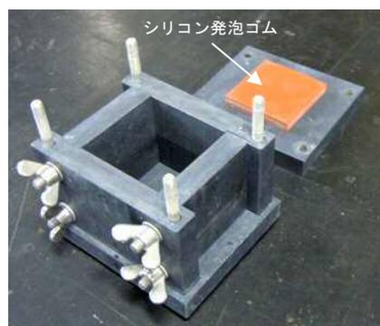
写真-1 促進養生型枠の外観
