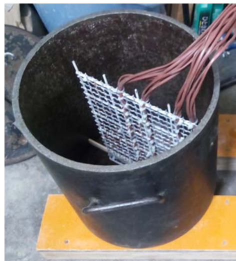
写真-3 熱電対の設置状況 2
