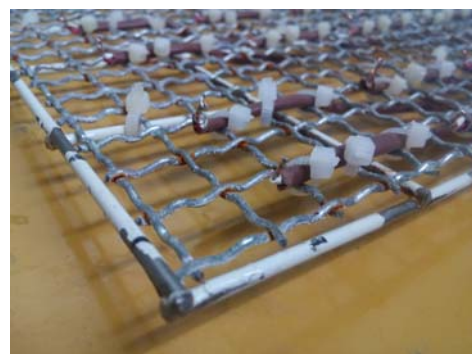
写真-2 熱電対の設置状況 1
