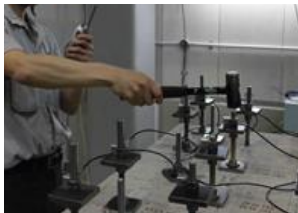
図-3 衝撃振動試験の状況(鉛直加振時)
