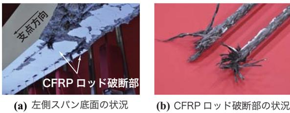
図-7 CFRP ロッドの破断状況 (RC-I-H3.0 試験体)
