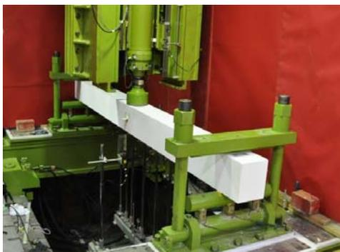
写真-1 衝撃荷重載荷時の実験装置と試験体設置状況
