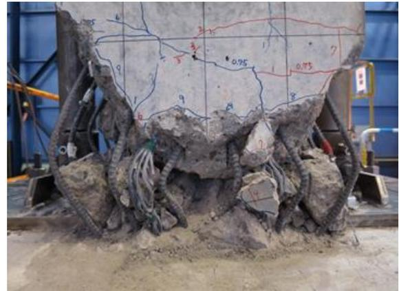
図-8 RC柱基部の損傷状況（供試体 B-D2）
