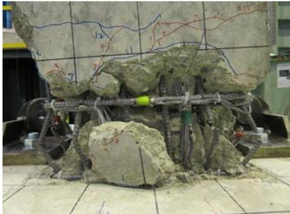
図-7 RC柱基部の損傷状況（供試体 A-D2）
