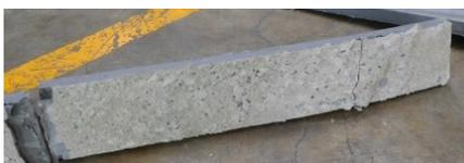
写真-2 剥落した UFC パネルの接着面の状況
