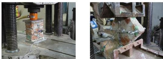
(1) 圧縮試験 (2) せん断試験
