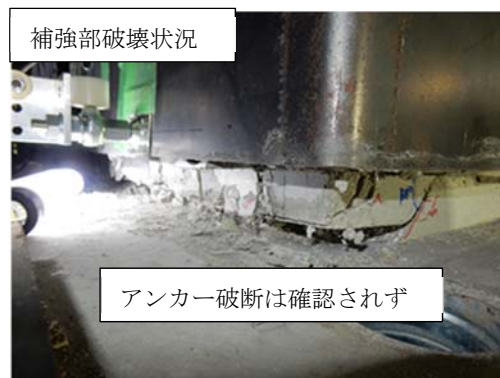
図-4 補修・補強試験体の杭頭部曲げモーメント-変形角関係および最終破壊状況
