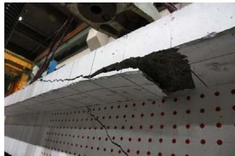
写真-1 圧縮フランジへのひび割れ進展状況 (T2. 5-017 試験体)
