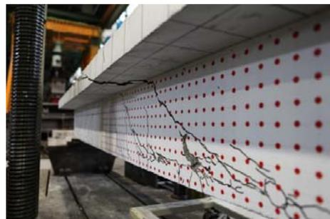
写真-2 圧縮フランジへのひび割れ進展状況 (T3. 5-0. 17 試験体)
