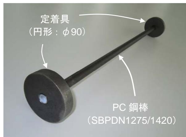
写真-1 使用した高強度中間帯鉄筋
