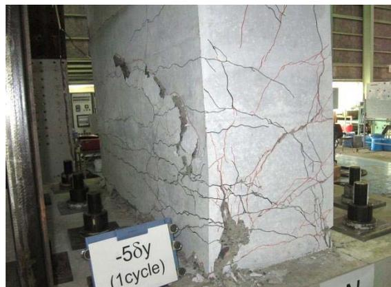
写真-3 かぶり剥落開始 (NB-PW009:  $5\delta_y$ )
