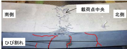
図-7 曲げ载荷による鉄筋コンクリート梁の破壊状況
