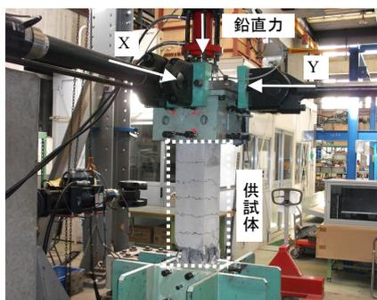
写真-1 二方向荷重装置
