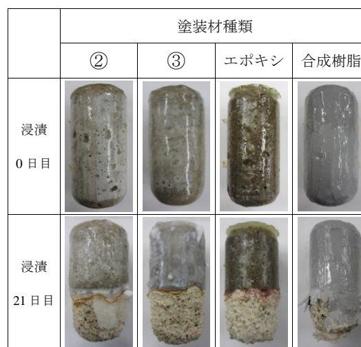
写真-3 円柱モルタルの外観
