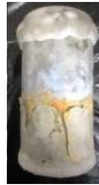
写真-8 隅角部を厚塗りした円柱モルタルの様子
