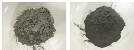
FA-2 FA-L SiO 2 58.94 59.36 Al 2 O 3 21.00 17.03 Fe 2 O 3 3.73 3.47 CaO 6.07 1.61 MgO 1.29 0.88 SO 3 0.50 0.35 Na 2 O 0.42 0.66 K 2 O 1.75 1.09 TiO 2 0.83 0.81 P 2 O 5 0.74 0.18 MnO 0.04 0.03 強熱減量 3.7 11.6 計 99.0 97.1
