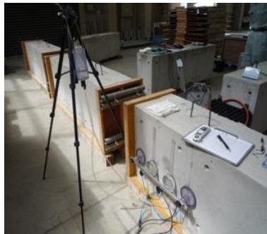
写真-4 表面吸水試験
