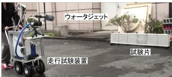
図-5 走行しながらの水撃音響法試験の様子
