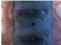
図-13 黒い酸化皮膜で覆われた状態の供試体
