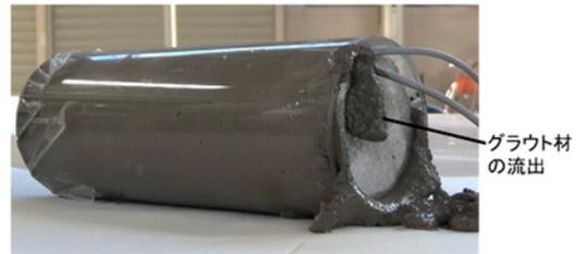
図-9 アクリルパイプによるグラウト実験状況
