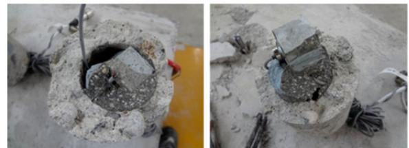
(a) インナーコア内の空隙 (b) 埋込みセンサの偏り
