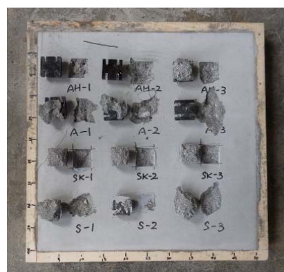
図－8 PCM 板における各試験の破断状況
