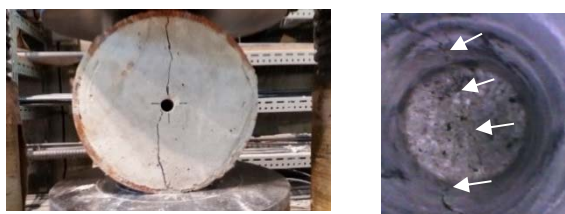
図-5 先行ひび割れ導入および坑内ひび割れ状況 (ファイバースコープ撮影)
