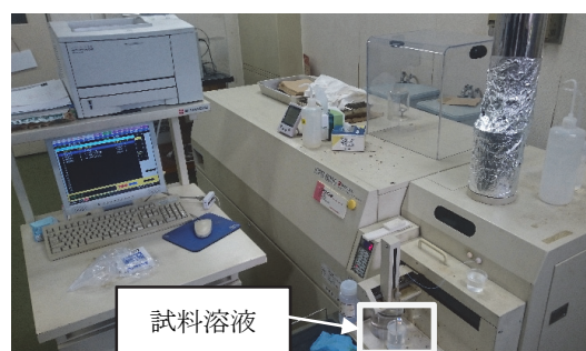
写真-1 本研究で使用した ICP 発光分析装置
