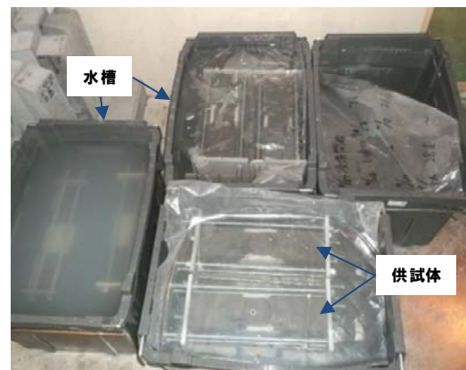
写真－2 恒温室水槽内での水中浸漬状況
