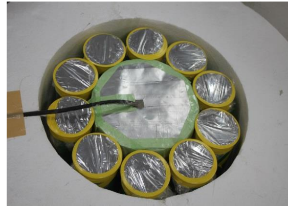
写真-1 簡易断熱温度上昇試験の概要
