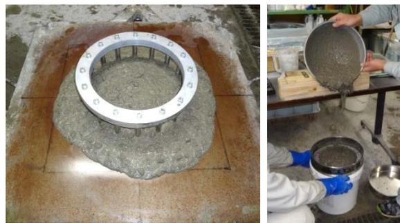
写真-1 J-Ring(左)および Sieve segregation(右) 試験状況
