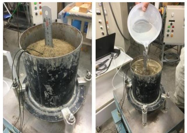
写真-1 間隙水圧の測定の様子
