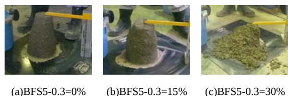
図-8 凍結融解試験を行ったコンクリートのフレッシュ性状
