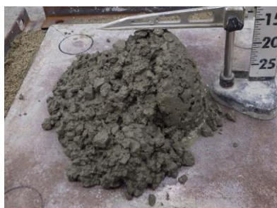
写真－２ 材料分離状況
