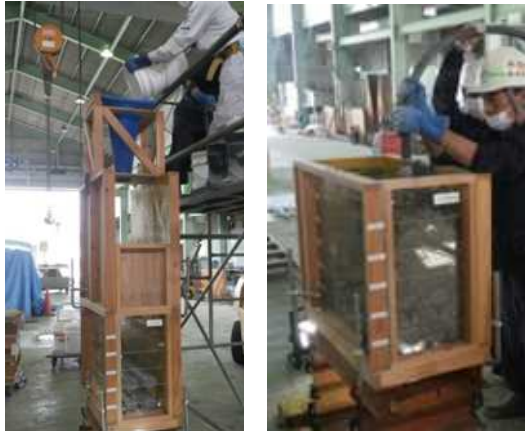
写真-2 打込みおよび締固め状況
