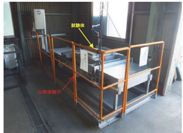
写真-5 繰返し加熱実験の状況
