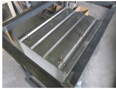
(b) 角波鋼板設置状況
