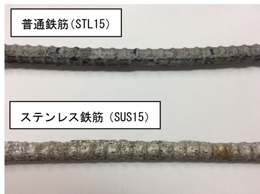
図-8 鉄筋腐食性状（シリーズ 1）
