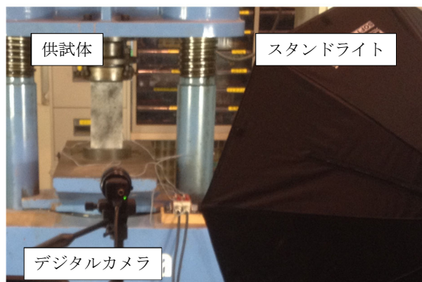
写真-2 圧縮载荷試験の状況
