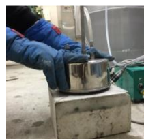
写真-4 平板供試体に吹き付け装置を設置した状況
