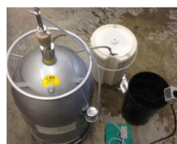
写真-1 円柱供試体を用いた簡易凍結融解試験装置
