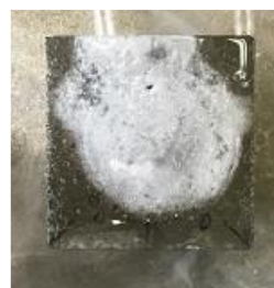
写真-6 吹き付け装置を外した直後の平板供試体
