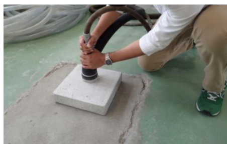
図－4 サンドブラスト法の試験状況
