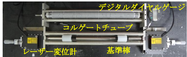
図-2 長さ変化測定装置
