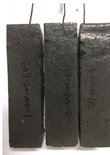
写真－1 遅れ膨張ひび割れ
