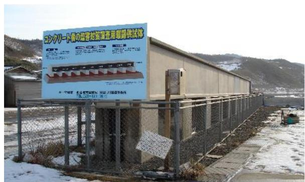
図-10 暴露試験桁
