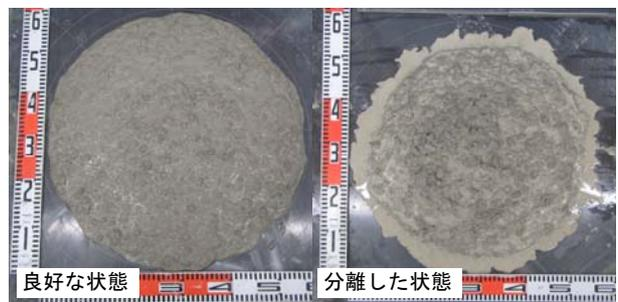
写真-3 スランプフローの状態の比較例
