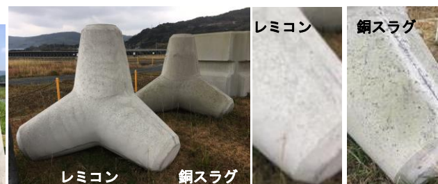
写真-4 ブロック表面の藻類（1 年 2 か月後の状態）
