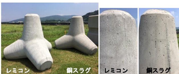
写真-2 製造直後のレミコンブロックと銅スラグブロック
