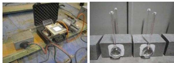
写真-2 透気試験状況
