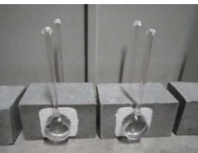
写真-3 吸水試験状況
