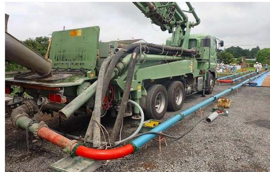
写真-1 ポンプ圧送性試験 (水平換算距離 150m)
