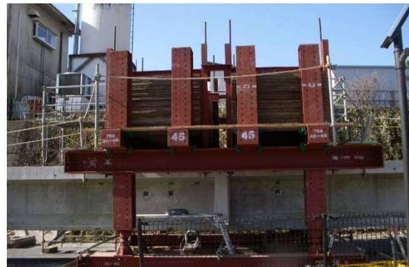
写真-4 荷重載荷位置(支間中央部)
