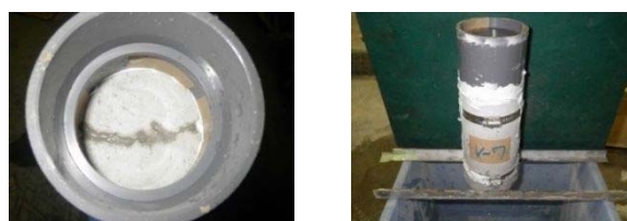
図-8 通水試験状況
