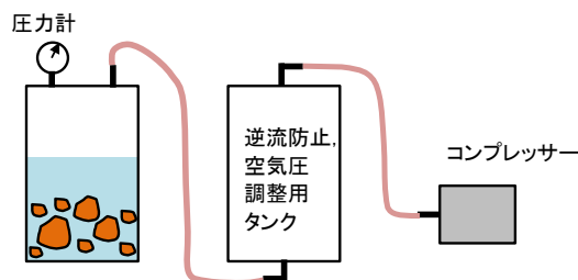
図-2 加圧吸水試験の模式図
