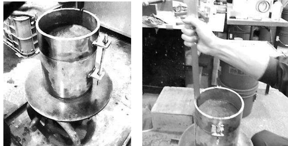
左：試験器具 右：沈下量の測定 写真-1 締固め性試験の状況
