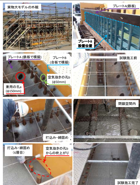
写真－７ 試験施工に用いたモデルの外観と実験状況
