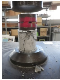
載荷後の供試体
