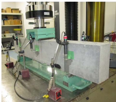
写真-2 100×200×1200 試験体 載荷状況
