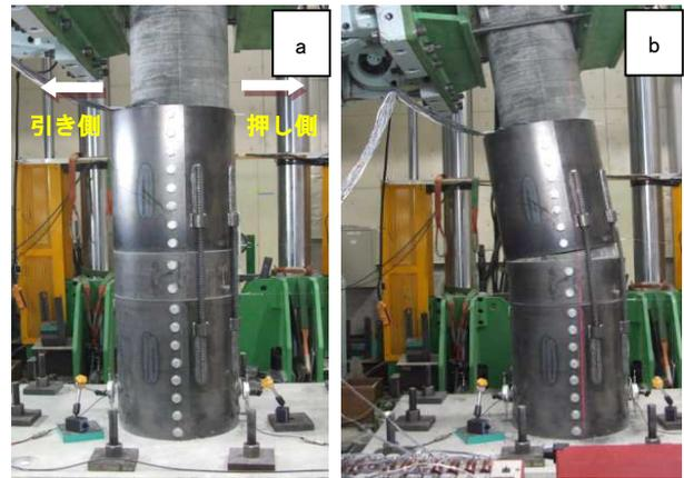
図-9 補強試験体No.2 荷重前(a) 荷重完了後(b)
