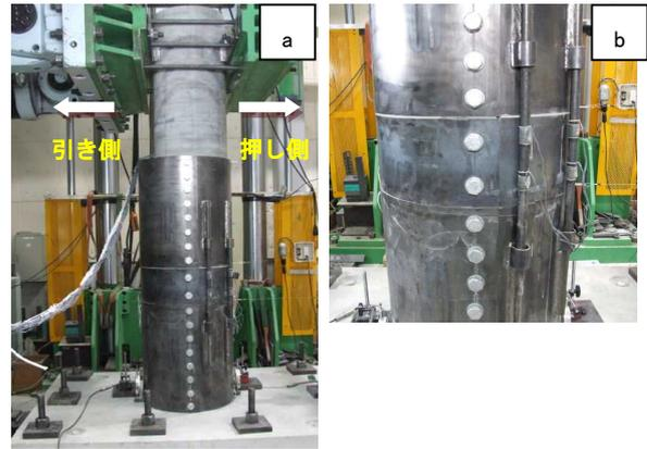
図-11 載荷前全景(a) 塑性ヒンジ部拡大(b)
